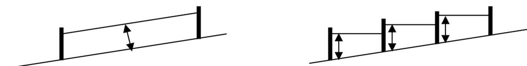
Elle est mesurée perpendiculairement à la pente ou à l'aplomb vertical en tout point de la clôture.
